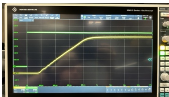
Obrázok 6: Odozva na jednotkový skok sústavy budič-motor-generátor-usmerňovač. Zelená krivka vstupné riadiace, žltá otáčky generátora.
